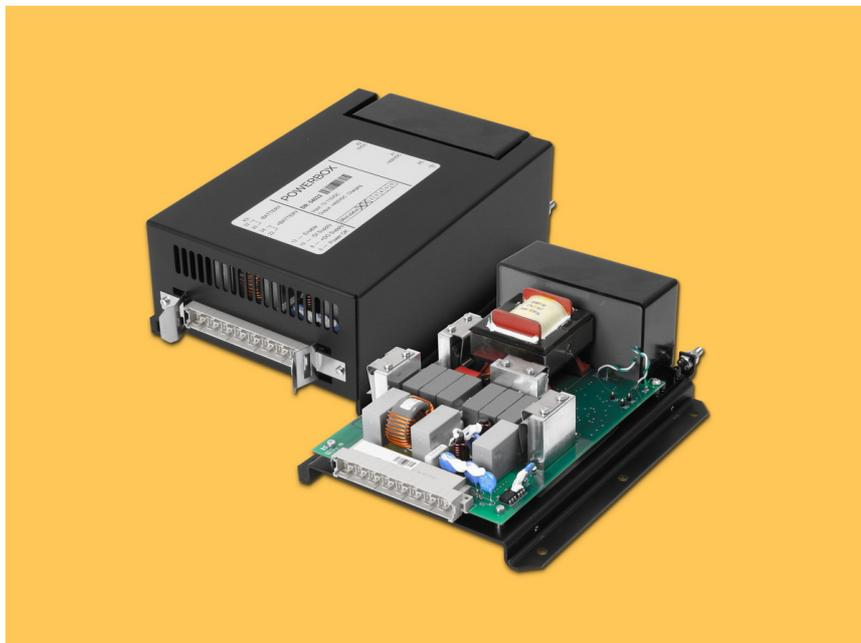
**Il precharger converte la tensione nominale del bus della batteria di 50VDC fino a 137,5VDC in una tensione di uscita regolata di 400VDC o 600VDC per caricare i banchi di condensatori ad alta tensione utilizzati per azionare gli attuatori delle valvole elettriche come ad esempio per sbloccare e sollevare i pantografi**
