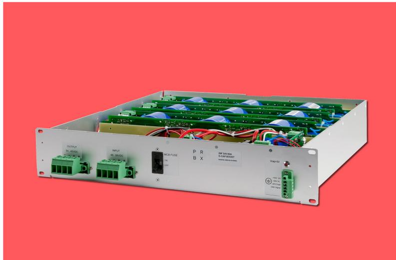
**Alojado en un chasis de 19" 2U, el 29F-54V-60A integra 22 supercondensadores, totalizando 29 Faradios y una capacidad de 2500W**
