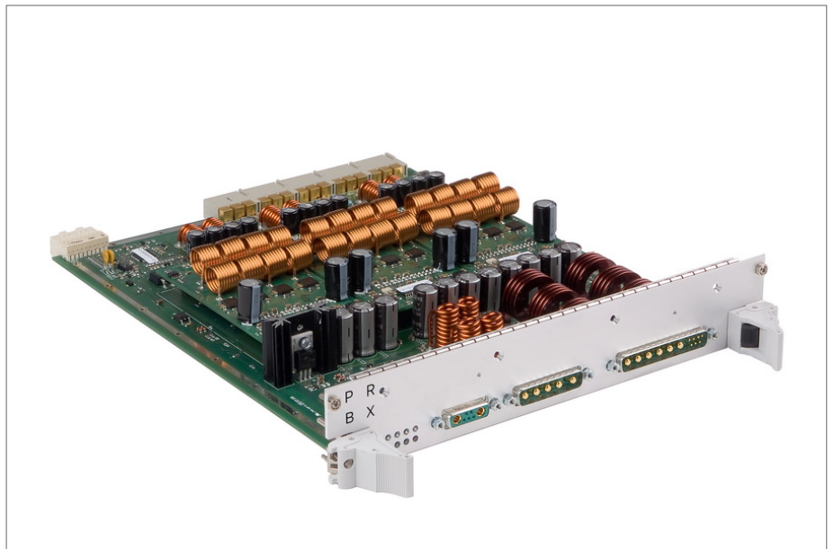
Power supply trifase senza nucleo utilizzando tre moduli GB350
