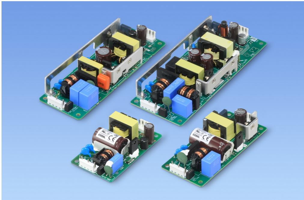
Mit einem Spannungsspektrum von 30 bis 100 W und Zertifizierung nach UL/EN62368-1 sind die Netzteile COSEL LHA30-50-75-100F für hoch anspruchsvolle Anwendungen geeignet.
