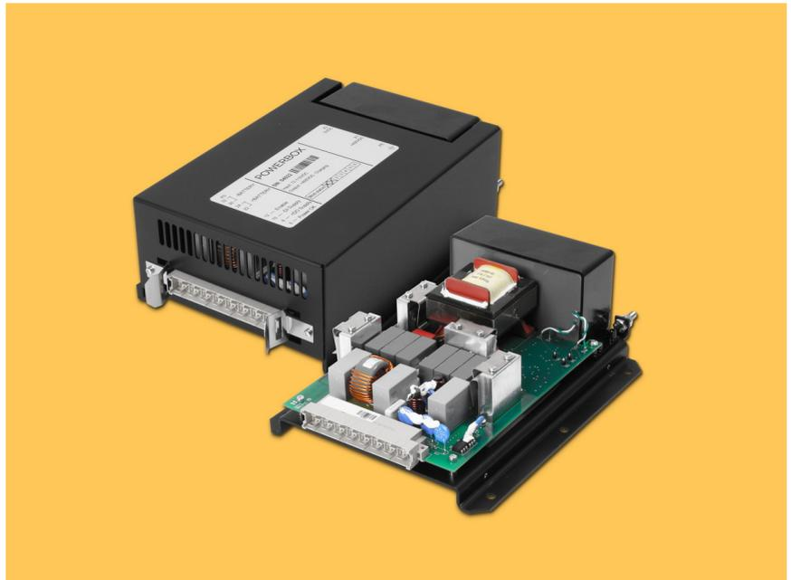
**Der Vorlader wandelt die Batterie-Nennspannung von 50VDC bis 137,5VDC in eine geregelte Ausgangsspannung von 400VDC oder 600VDC um, um Hochspannungskondensatorbänke zu laden, die zum Schalten von Stellgliedern für elektrische Ventile verwendet werden, wie beispielsweise zum Entriegeln und Anheben von Stromabnehmern.**
