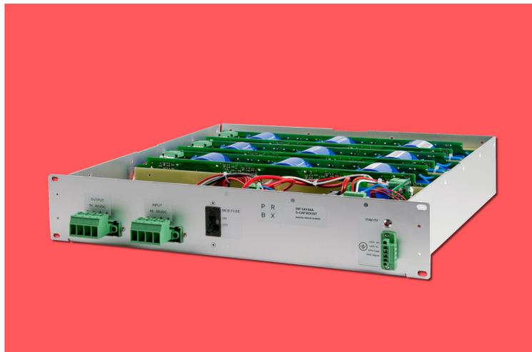
**In einem 19" 2U Chassis integriert das 29F-54V-60A insgesamt 22 Superkondensatoren mit einer Kapazität von 29 Farad und einer Leistung von 2500W.**
